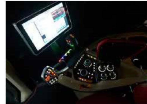
Los iconos de todos los interruptores se retroiluminan al encender las luces.
